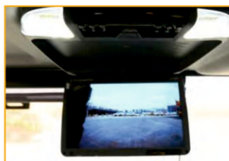
Камера заднего вида, установленная в кабине, облегчает парковку и помогает избежать повреждений.
