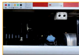
Устройство пуска и остановки двигателя и переключатель высокой и низкой скорости акселератора находятся в зоне управления аутригером, что обеспечивает легкость применения.
