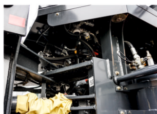
Подшипниковое шарнирное сочленение узла фронтального погрузчика LIUGONG
