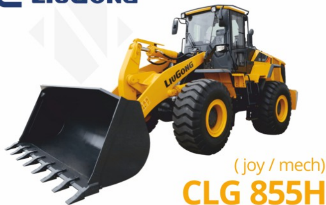
Кабина с сертифицированной защитной конструкцией (ROPS/FOPS). Обзор на 309 градусов.
