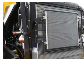
Однослойный радиатор и разреженное оребрение для высокой эффективности и простоты обслуживания.
