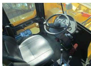
Кабина машины усилена, оборудована системами безопасности FOPS и ROPS.
