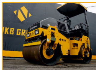
Технологии вибрации высокой частоты и низкой амплитуды LiuGong .
