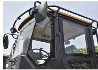
Эргономичная кабина (ROPS-FOPS) имеет обзор на 360°, установлены поручни по всей кабине
