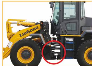
Вал расположен выше шарнирно-сочлененного соединения
