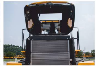
Опрокидывающийся капот двигателя упрощает проведение ТО
