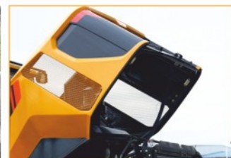
Опрокидывающийся капот двигателя для удобного обслуживания
