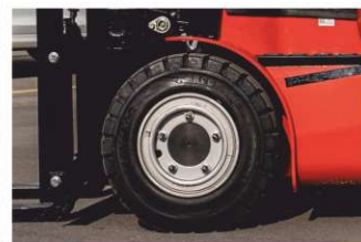
Установка цельнолитых непрокальваемых шин изначально с завода
