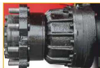
Система мокрого тормоза обеспечивает максимальный срок службы тормозной системы
