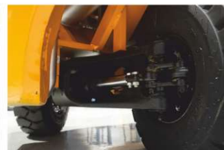
Усиленная задняя балка с шкворнями и поворотными тягами
