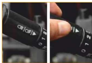
Трехступенчатая трансмиссия с максимальной скоростью 26 км/ч
