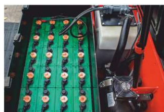
Максимально смещенная батарея назад к противовесу, увеличивает устойчивость и остаточную грузоподъемность на высоте
