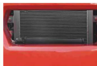
Система охлаждения, оборудованная цельным металлическим радиатором с диффузором
