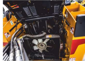
Радиатор отличается большой площадью, увеличенной дистанцией между ребрами и возможностью вращения, что облегчает процесс его очистки.
