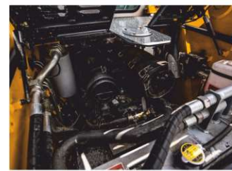
Трехступенчатый топливный фильтр «папо» и новый масляный фильтр ДВС увеличивают интервал обслуживания до 500 ч.
