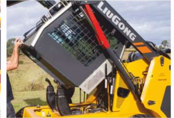
Подъемная кабина может быть наклонена до 80°, ключевые компоненты видны с первого взгляда, что удобно для обслуживания
