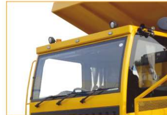
Просторная кабина с более широким обзором имеет шумоизоляцию
