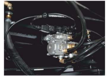
Рабочая тормозная система - WABCO , пневматическая, двухконтурный привод раздельно к тормозам передних и задних колес, тормозные механизмы дискового типа на всех колесах, ABS .
