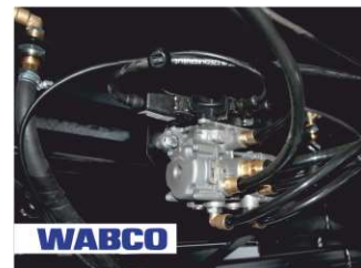
Рабочая тормозная система - WABCO , пневматическая, двухконтурный привод раздельно к тормозам передних и задних колес, тормозные механизмы барабанного типа на всех колесах, ABS .
