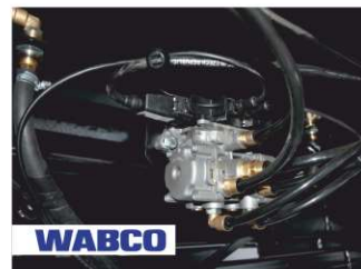
Рабочая тормозная система - WABCO , пневматическая, двухконтурный привод отдельно к тормозам передних и задних колес, тормозные механизмы барабанного типа на всех колесах, ABS .
