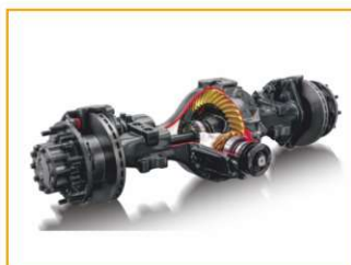
Одноступенчатый редукторный мостери и МСУ13 - это новый одноступенчатый редукторный ведущий мост, разработанный компанией SINOTRUK на основе технологии ведущего моста MAN.
