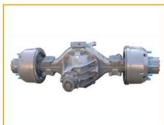
Передняя ось: 9,5T MAN зависимая, балансирующая на полуэллиптических рессорах. Задняя ось: 16T MAN , зависимая, на продольно расположенных полуэллиптических рессорах, с телескопическими амортизаторами.
