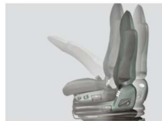
Сиденье с подушкой: Просторное и комфортное сиденье оснащено регулируемой воздушной подушкой.
