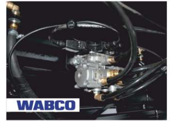
Рабочая тормозная система - WABCO , пневматическая, двухконтурный привод раздельно к тормозам передних и задних колес, тормозные механизмы барабанного типа на всех колесах, ABS .
