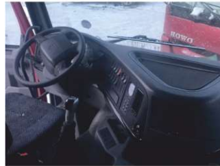
Кабина оснащена кондиционером, магнитофоном, системой отопления и сиденьем с гидравлической амортизацией
