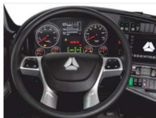
Руль с пневматической регулировкой, удобные переключатели для управления. Эта модель имеет электрические стеклоподъемники.
