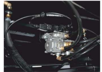
Рабочая тормозная система - WABCO , пневматическая, двухконтурный привод раздельно к тормозам передних и задних колес, тормозные механизмы барабанного типа на задних колесах, ABS .
