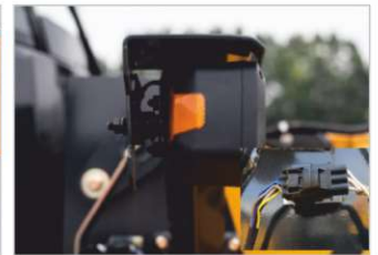
Регулируемый передний фонарь с защитой от вибрации
