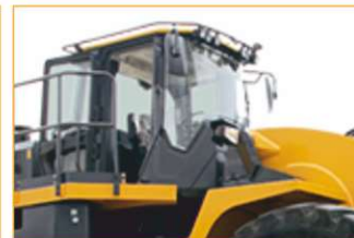
Кабина с сертифицированной защитной конструкцией (ROPS/FOPS).
