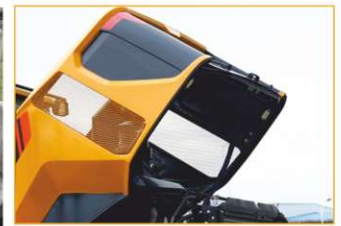
Опрокидывающийся капот двигателя для удобного обслуживания
