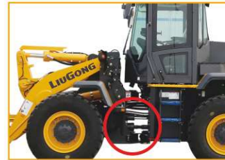
Вал расположен выше шарнирно-сочлененного соединения
