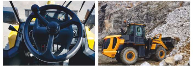
Угол схождения полурам до 40°, отличный обзор с кабины до 360°. Кабины обеспечены печкой и кондиционером и спроектированы для удобства работы оператора
