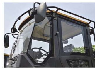
Эргономичная кабина (ROPS-FOPS) имеет обзор на 360°, установлены поручни по всей кабине
