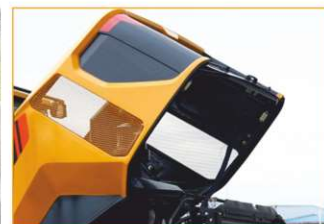
Опрокидывающийся капот двигателя для удобного обслуживания
