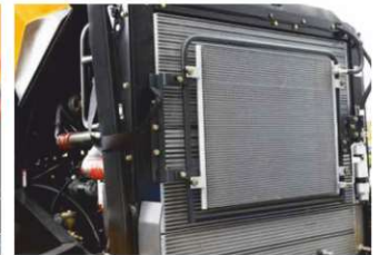
Однослойный радиатор и разреженное оребрение для высокой эффективности и простоты обслуживания.
