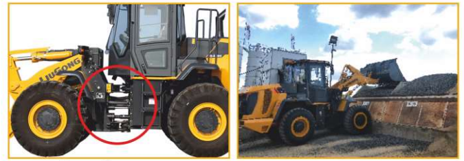
Основной вал расположен выше шарнирно-сочлененного соединения, что увеличивает ресурс техники и обеспечивает от непредвиденных поломок в экстремальных условиях
