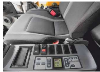
Усовершенствованная система климат-контроля
