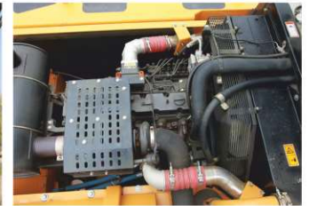
Двигатель Cummins 6BTAА5.9-C с увеличенной выходной мощностью
