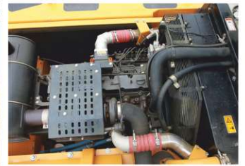
Двигатель Cummins 6C-8.3 с увеличенной выходной мощностью
