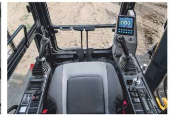
Система Power Boost позволяет увеличить мощность гидросистемы для резкого увеличения вырывного усилия
