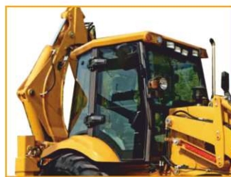
Кабина ROPS (Защита при опрокидывании) рама безопасности, предназначенная для защиты оператора при опрокидывании машины.
