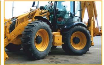
CLG 777A S – это полноприводный с равновеликими колесами и крабовым ходом
