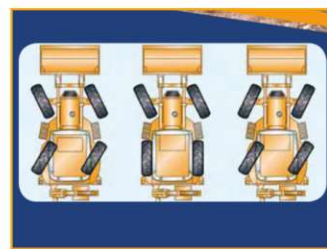
Заднее шасси может поворачиваться вокруг центра, обеспечивая хорошее сцепление колес с грунтом, что дает преимущества экскаватору-погрузчику легко перемещаться по пересеченной местности. Угол поворота шасси ° 35 ± 1 Угол поворота задней оси ° ± 10
