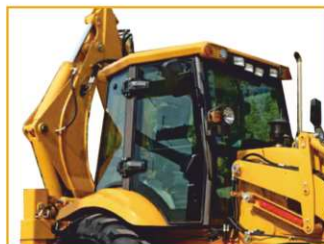
Кабина ROPS (Защита при опрокидывании) рама безопасности, предназначенная для защиты оператора при опрокидывании машины.
