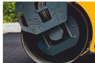
Возможность работать в высокочастотном режиме 67 Гц.
