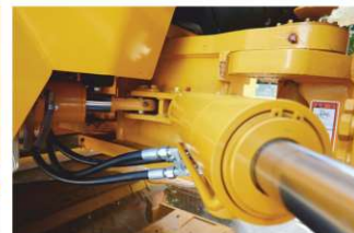
Опция смещения валцов относительно друг друга в стороны на 160мм.
