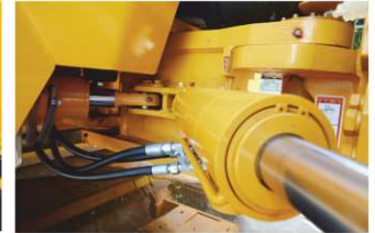
Опция смещения валцов относительно друг друга в стороны на 160 мм
