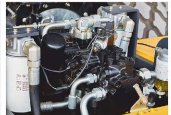
Простой и надежные двигатель Shangchai SC4H140.2G2
