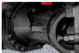
Плавающая управляемая ось позволяет любому колесу преодолевать препятствия, сохраняя баланс погрузчика и груза
