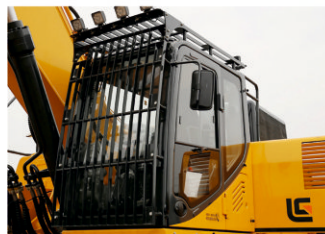
Герметичная и защищенная кабина, усовершенствованная система климат-контроля и подогрев лобового стекла.
