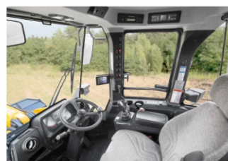
Кабина с сертифицированной защитной конструкцией (ROPS/FOPS). Обзор на 309 градусов.
