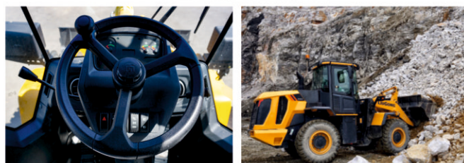
Угол схождения полурам до 40°, отличный обзор с кабины до 360°. Кабины обеспечены печкой и кондиционером и спроектированы для удобства работы оператора
