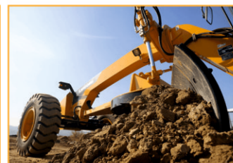
Автогрейдер может работать в более стесненных условиях, поскольку радиус поворота уменьшен до 7,2 м
