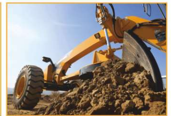
Автогрейдер может работать в более стесненных условиях, поскольку радиус поворота уменьшен до 7,2 м
