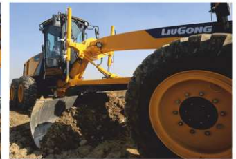
Запатентованная система поворота Liugong дополнительно помогает оператору, позволяя врезаться в землю на глубину 60-270 мм без ущерба для стабильности или контроля.
