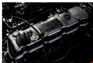
Мощный и надежный бензиновый двигатель от Nissan устанавливается на ряд погрузчиков известных брендов более 10 лет (Komatsu, Mitsubishi, TCM, HC)
