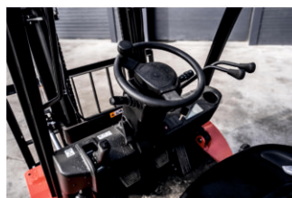
Переключение передач осуществляется под рулевым джойстиком для удобства работы оператора
