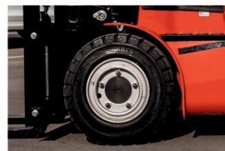
Установка цельнолитых непрокальваемых шин изначально с завода
