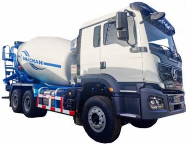
Передняя ось: 7.5T MAN зависимая, балансирующая на полуэллиптических рессорах. Задняя ось: 16T MAN , зависимая, на продольно расположенных полуэллиптических рессорах, с телескопическими амортизаторами.)
