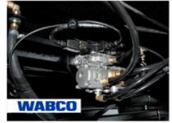
Рабочая тормозная система - WABCO , пневматическая, двухконтурный привод отдельно к тормозам передних и задних колес, тормозные механизмы барабанного типа на всех колесах, ABS
