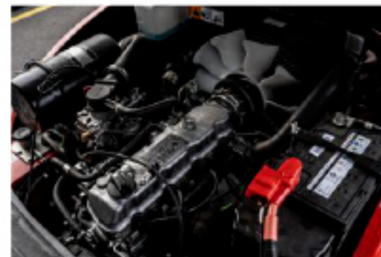
Мощный и надежный бензиновый двигатель от Nissan устанавливается на ряд погрузчиков известных брендов более 10 лет (Komatsu, Mitsubishi, TCM, HC)
