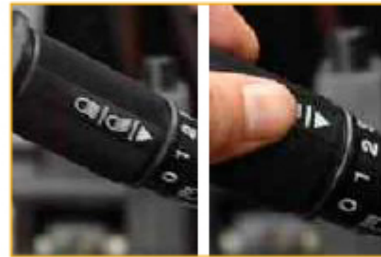
Трехступенчатая трансмиссия с максимальной скоростью 26 км/ч
