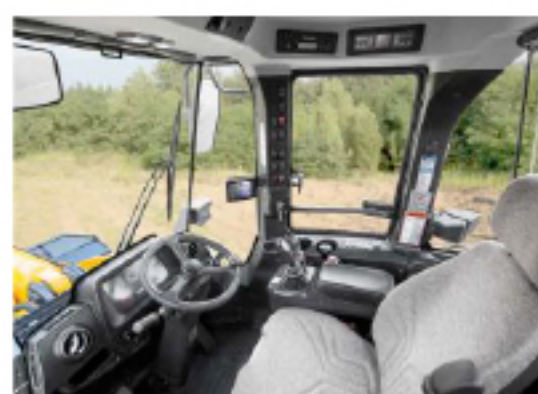
Кабина с сертифицированной защитной конструкцией (ROPS/FOPS). Обзор на 309 градусов.
