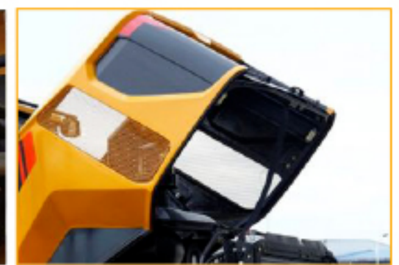
Опрокидывающийся капот двигателя для удобного обслуживания
