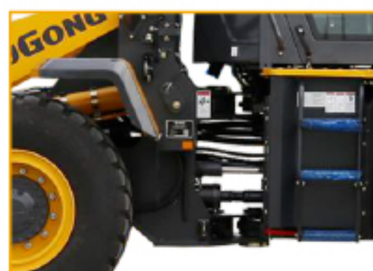
Подшипниковое шарнирное сочленение узла фронтального погрузчика LIUGONG
