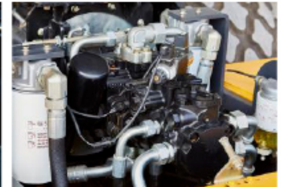
Простой и надежный двигатель Shangchai SC8D180.3G2B1
