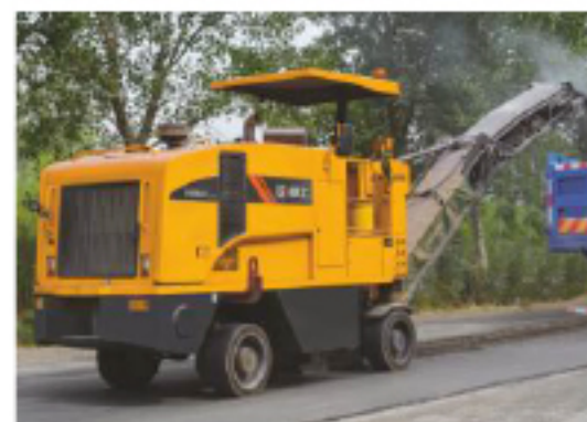
Технология ротационного фрезерования под высоким давлением
