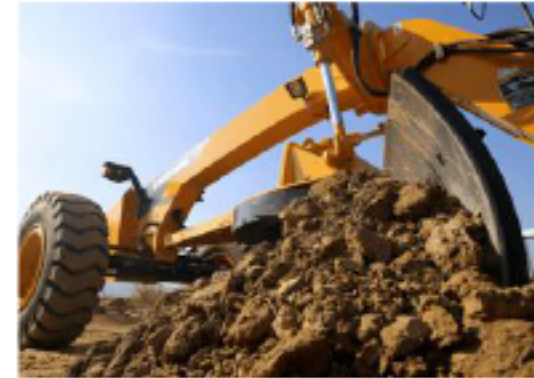
Автогрейдер оборудован поворотной платформой, что позволяет ему нивелировать боковые уклоны и откосы
