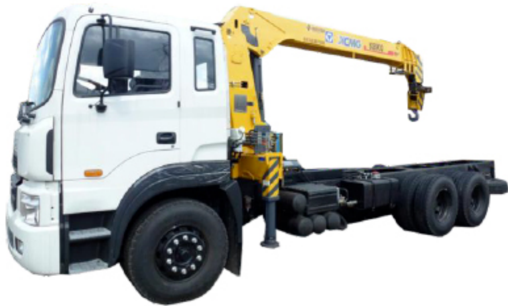
Рабочая платформа установлена на шарикоподшипниковом опорно-поворотном кольце, что дает возможность оператору совершать непрерывный поворот на 360 градусов по замкнутому контуру
