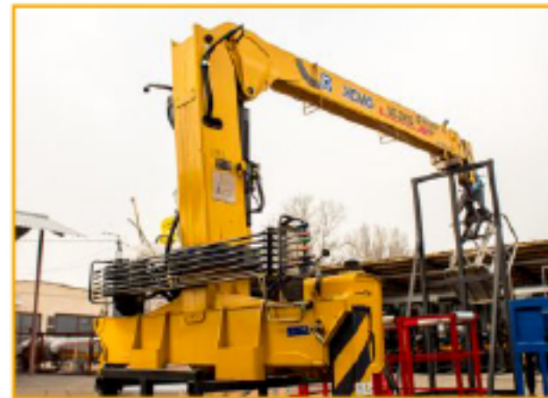
Рабочая платформа установлена на шарикоподшипниковом опорно-поворотном кольце, что дает возможность оператору совершать непрерывный поворот на 360 градусов по замкнутому контуру
